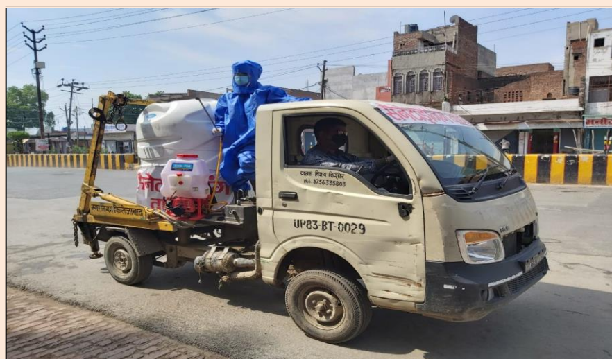
पेट्रोल चालित टाटा एस पर अधिष्ठापित क्षमता 1000 लीटर
